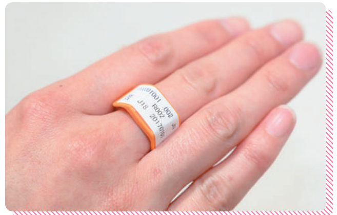
指にはめるタイプのガラスリング。指先の部分の放射線量を測る
