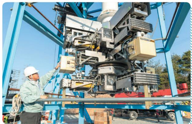
排気筒を内側から切断する内周切断装置。岡井さんが触れているのが、苦労してつくったボックスだ
